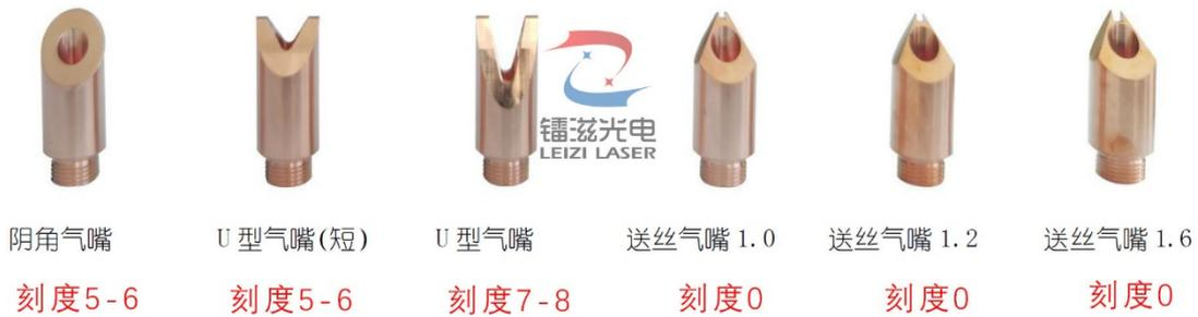
指导焦点刻度都为正刻度，既刻度为 0 往外为正刻度，往里为负刻度。根据不同送丝嘴指导焦点进行±微调，焦点出光声音清脆滋滋声，且没有明显噗噗的火团，会有少量滋滋的火星。
